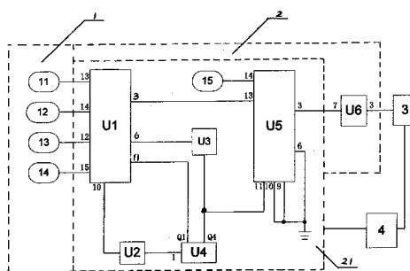
1、一种大气湍流和气象探空仪，包括依次联接的传感部件（1）、信号变换部件（2）和发射机（3）以及电源（4），其特征在于：
