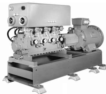
图 7 Stirling C&R 公司的 SPC-4 制冷机
