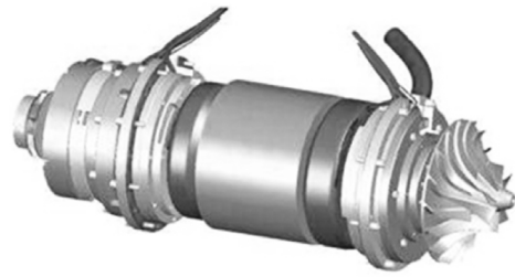
图 14 采用气体轴承或磁轴承的制冷机 [20]
