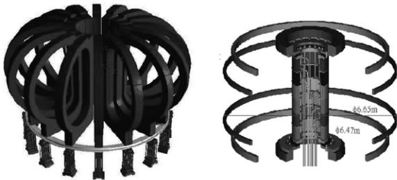
图 1 EAST 纵场磁体及其支撑和极向场磁体示意图
