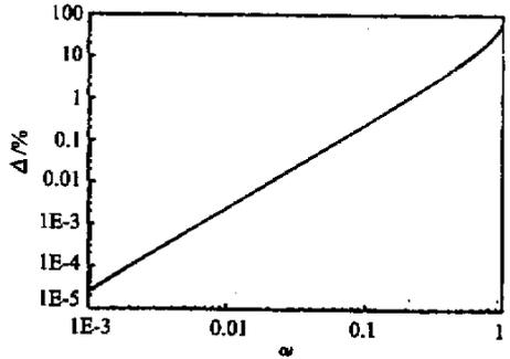
图5 Voigt 模型振动系统的误差函数  $\Delta$  随频率变化的曲线 ( $\kappa = \eta = 1$ )
