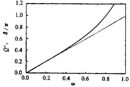
图4 Voigt 模型振动系统的  $\frac{\delta}{\pi}$  (实线) 和试样内耗 (虚线) 与频率  $\omega$  的关系曲线 ( $\kappa = \eta = 1$ )
