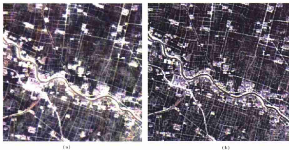
图 6 2005 年 11 月 30 日安徽淮南及周边地区 CCD 图像大气订正效果比较 (a) 1, 2, 3 波段原始图像彩色合成; (b) 大气订正后 1, 2, 3 波段彩色合成图
