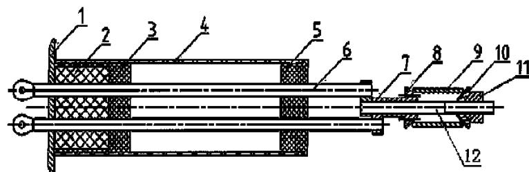
1. 超导股线临界电流测试样品杆，包括有密封法兰、电流引线、样品夹紧装置等，其特征在于：所述的密封法兰内有低温环氧胶密封，密封法兰外套装有环氧护套，环氧护套内分别设置有左支撑胶木环、右支撑胶木环；所述的样品夹紧装置上、下端分别安装有上压紧环、下压紧环，上压紧环和下压紧环分别连接电流引线两极，电流引线两极之间隔有高压绝缘层，上压紧环与下压紧环之间固定超导股线样品骨架，样品骨架外壁绕制有超导股线，超导股线的两端分别连接到上压紧环、下压紧环上，二根电流引线分别依次穿过密封法兰、低温环氧胶、左支撑胶木环、右支撑胶木环且通过接头装置与导电螺杆固定连接；上压紧环、下压紧环分别与两根电流引线连接。
