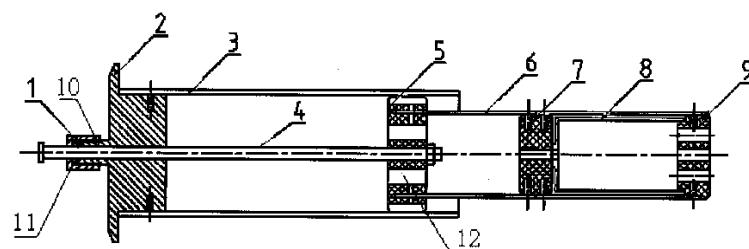
1. 导体 RRR 值的测试样品杆,包括有密封法兰,其特征在于 :所述的密封法兰的左侧带有伸出端,密封法兰外固定套装有环氧护套,密封法兰内穿过有调整杆,所述的伸出端外螺纹联接有密封螺帽,密封螺帽后端与伸出端之间垫有套装于调整杆上的密封圈,调整杆的前端固定安装有可沿环氧护套内壁滑动的支撑胶木环,支撑胶木环外侧固定安装有隔离环氧护套,隔离环氧护套内安装有上固定胶木环、下固定胶木环,上固定胶木环与下固定胶木环之间安装有紫铜加热器,紫铜加热器外壁具有螺纹,螺纹内缠绕有加热丝。
