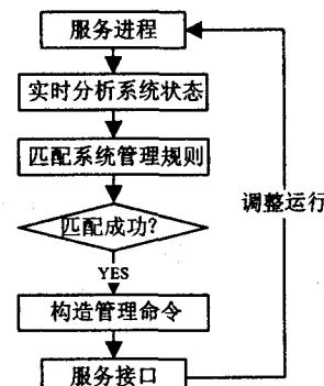
图 2 管理程序处理流程
