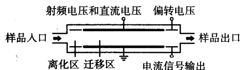
图1 FAIMS 迁移管结构示意图
