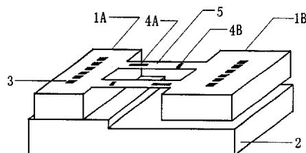
1. 一种硅微机械倾角传感器，其特征在于：传感器包括硅质量块(1)A、硅质量块(1)B、具有一级台阶的玻璃衬底(2)、电极(3)、压敏电阻(4)A、压敏电阻(4)B、硅应变梁(5)，其结构是由两个大小不同的硅质量块(1)A、硅质量块(1)B和连接它们的两个相互平行的硅应变梁(5)和下面的具有一级台阶的玻璃衬底(2)构成；
