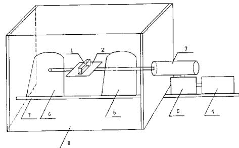
1、倾角仪零点和灵敏度温度补偿装置，其特征在于：包括补偿装置框架、电机及其驱动器、控制器和高低温实验箱，
