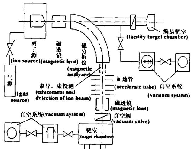
图2 离子束生物工程装置示意图
