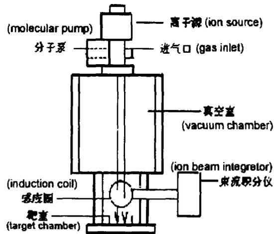
图1 离子束辐照装置简图
