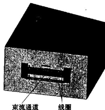
图3 线圈及其铁轭的结构图
