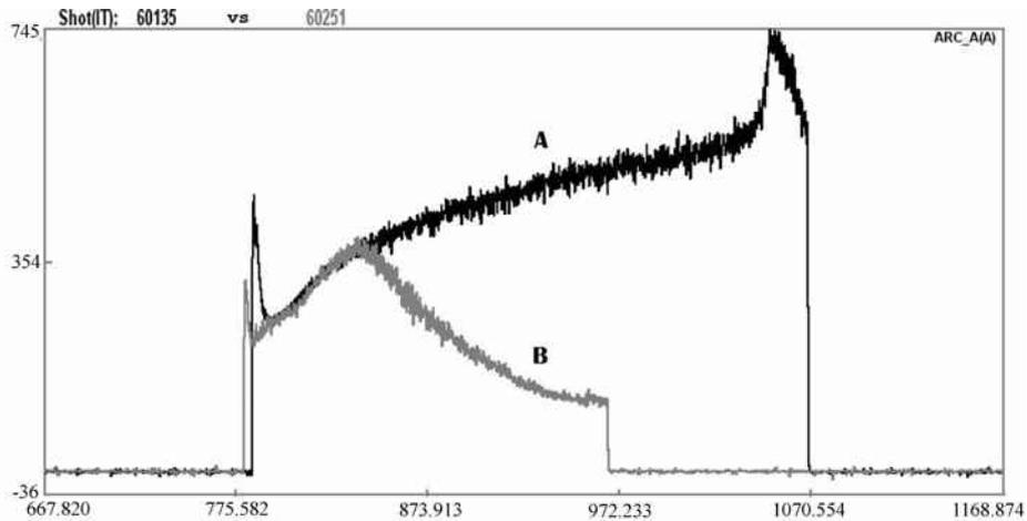
图 7 实时反馈控制与未采用实时反馈控制下的离子源放电弧流波形比较
