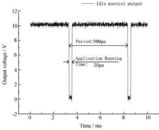
图 4 系统空闲时输出电压曲线
