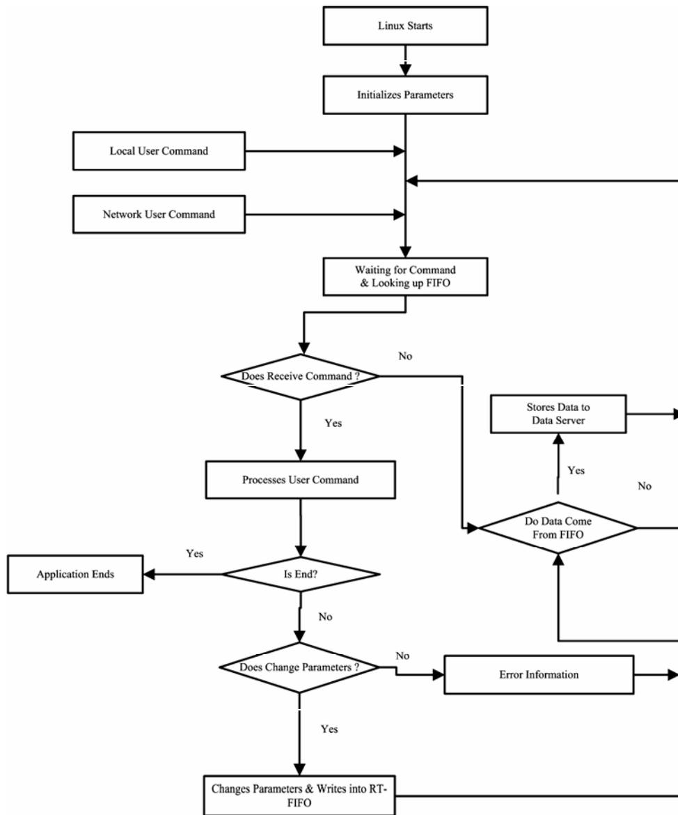
图 3 Linux 程序工作流程图
