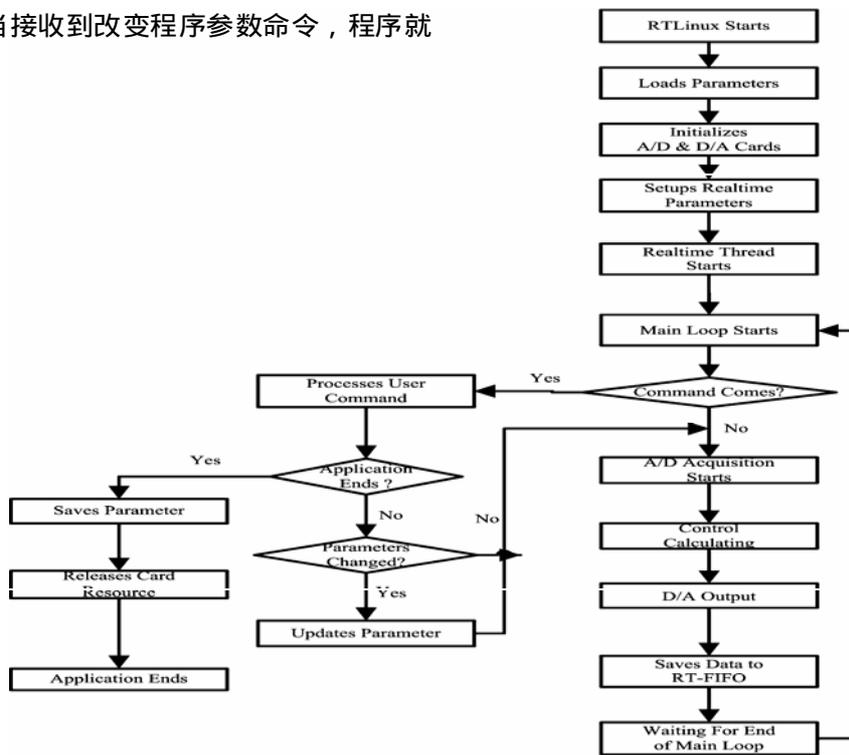
图 2 RTLinux 程序工作流程图
