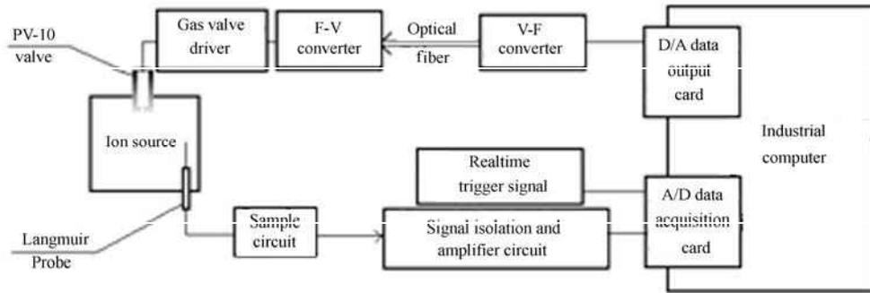
图 1 实时反馈控制系统硬件连接示意图
