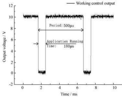
5 系统工作时输出电压曲线
