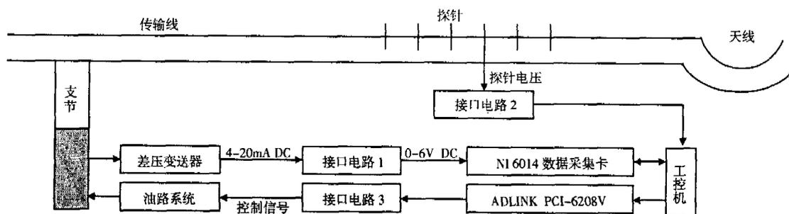
图7 液态调配器计算机控制系统的原理图
