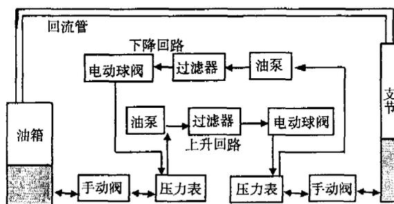
图 4 液态调配器硬件装置示意图
