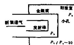
图1 提高阴极发射电流密度 J_e 的措施
