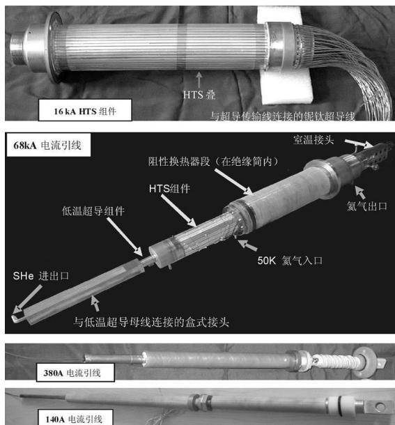
图 2 在等离子体物理所开发的 HTS 电流引线照片
