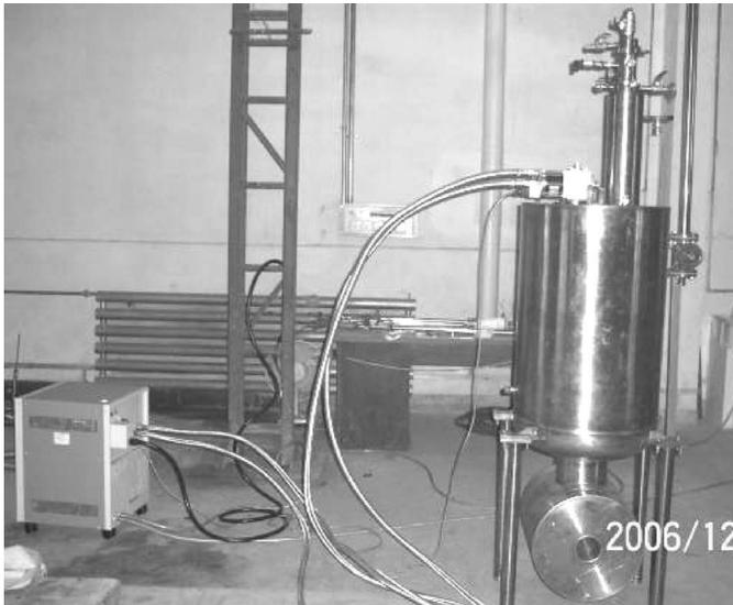
图 1 采用 HTS 电流引线的由 GM 微型制冷机供冷的铌钛超导磁体
