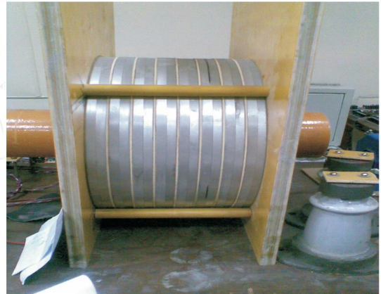
图4 铁心缓冲器实验装置 Fig. 4 Core snubber
