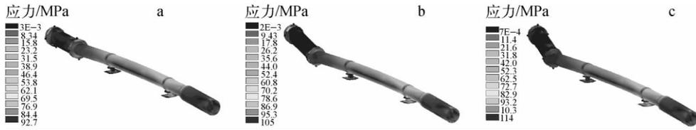
图7 设计有万向节的过渡馈线上的 Tresca 应力分布
