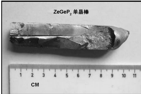
图 1 用水平温梯冷凝法生长的 ZnGeP 2 单晶 Fig 1 ZnGeP 2 single crystal grown by HFG
