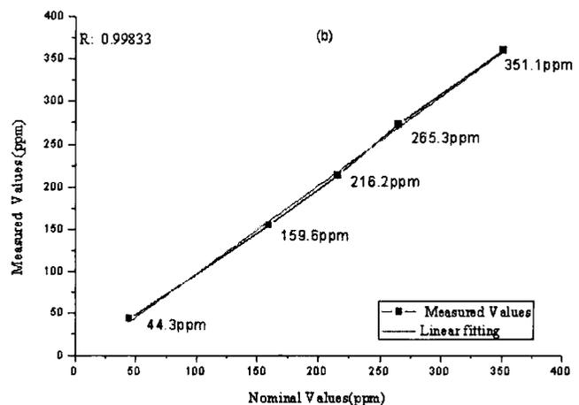
(b) SO<sub>2</sub> 测量相关度
