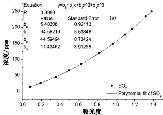
图 2 利用三阶多项式拟合获得的 SO<sub>2</sub> 定标曲线
