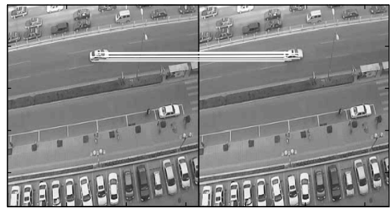
图 2 基于 MSFE 算法的目标配准结果
