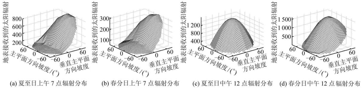
图 2 不同时间地表接收的太阳辐射度随坡度坡向变化的三维分布图
