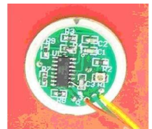
(b) PCB 板信号处理电路实物图
