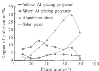
图 7 空间目标不同材料的偏振特性曲线
