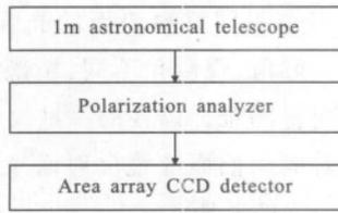
图 2 实验系统总体组成框图
