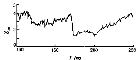
图 6 靶丸注入时 Z_{\text{eff}} 变化(170 ms 处)
