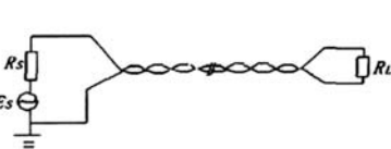
图 3.2 双绞线层单端接地
